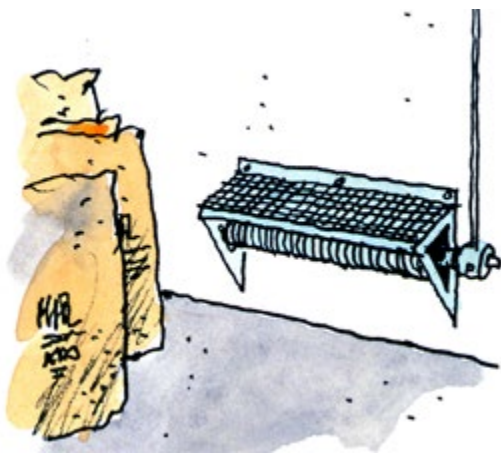
Elradiatorer med övertäckningsskydd.
