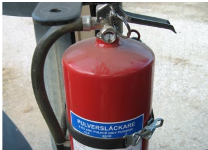
På flera typer av maskiner måste det finnas brandsläckare. Läs om kraven på sidan 8.
