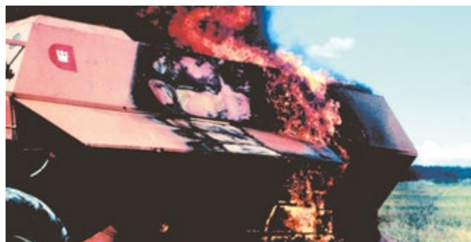
Undvik brand i din tröska. Blås ren tröska med tryckluft efter varje tröskningsdag.
